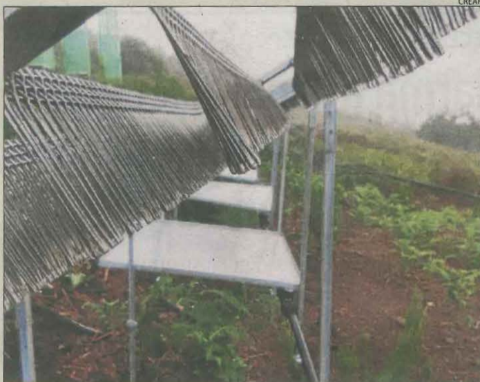
Equips per captar aigua de boira a les illes Canàries.
